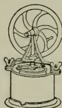
Centrifuge (over driven)
